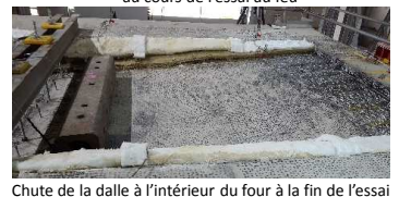
Chute de la dalle à l'intérieur du four à la fin de l'essai
